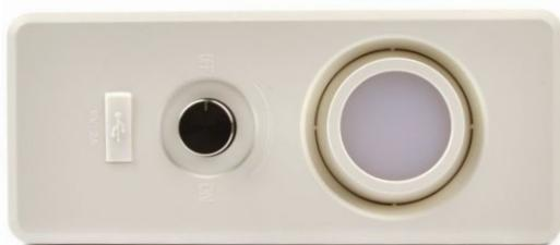
Встраиваемый прикроватный светодиодный светильник предназначен для локального освещения в бытовых и служебных помещениях. Мощный светодиод даёт направленный световой поток смягчённый матовой линзой. На лицевой части корпуса расположены поворотный диммер, позволяющий регулировать мощность от 0,3W до 5W, и розетка USB для подключения бытовых приборов с небольшим рабочим током. Светильник защищён от пыли и влаги.
