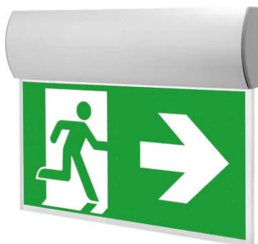
Светильник указатель светодиодный накладного монтажа применяется для указания путей эвакуации в жилых, служебных и производственных помещениях. При потере питания в сети включается аварийное питание от встроенной батареи обеспечивающей работу в течении 180 минут. Монтаж на подволосок и переборку. По требованию заказчика световая панель может изготавливаться разного цвета и с различными надписями (ВЫХОД, К ШЛЮПКАМ, ГАЗ УХОДИ и т.п.)
