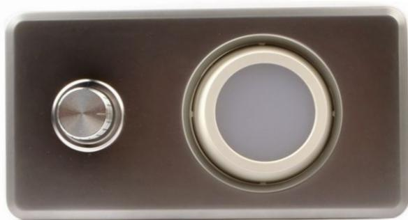
Встраиваемый прикроватный светодиодный светильник предназначен для локального освещения в бытовых и служебных помещениях. Мощный светодиод даёт направленный световой поток смягчённый матовой линзой. На лицевой части корпуса расположены поворотный диммер, позволяющий регулировать мощность от 0,3W до 3W. Светильник защищён от пыли и влаги.
