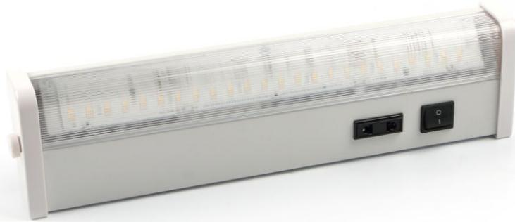
Прикроватный светодиодный светильник накладного монтажа предназначен для локального освещения в бытовых и служебных помещениях. Светодиодная матрица и пускорегулирующее устройство расположены внутри корпуса. Рассеиватель из ударопрочного поликарбоната смягчает световой поток и защищает токоведущие части светильника от пыли и загрязнений. На лицевой части корпуса расположен выключатель и розетка для подключения бытовых приборов с небольшим рабочим током.
