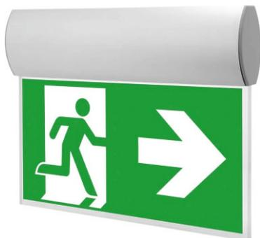
Светильник указатель светодиодный накладного монтажа применяется для указания путей эвакуации в жилых, служебных и производственных помещениях. При потере питания в сети включается аварийное питание от встроенной батареи обеспечивающей работу в течении 180 минут. Монтаж на подволок и переборку. По требованию заказчика световая панель может изготавливаться разного цвета и с различными надписями (ВЫХОД, К ШЛЮПКАМ, ГАЗ УХОДИ и т.п.)
