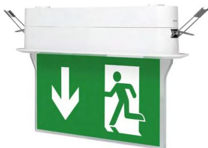
Светильник указатель светодиодный встраиваемый применяется для указания путей эвакуации в жилых, служебных и производственных помещениях. При потере питания в сети включается аварийное питание от встроенной батареи обеспечивающей работу в течении 180 минут. Монтаж на подволок и переборку. По требованию заказчика световая панель может изготавливаться разного цвета и с различными надписями (ВЫХОД, К ШЛЮПКАМ, ГАЗ УХОДИ и т.п.)
