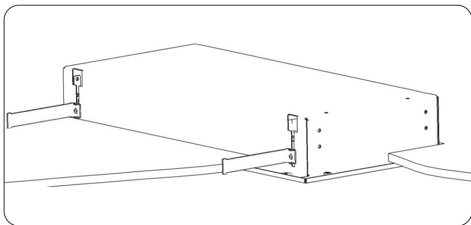
\*допускается установка светильников без использования монтажных кронштейнов на заклепки к подволоку
