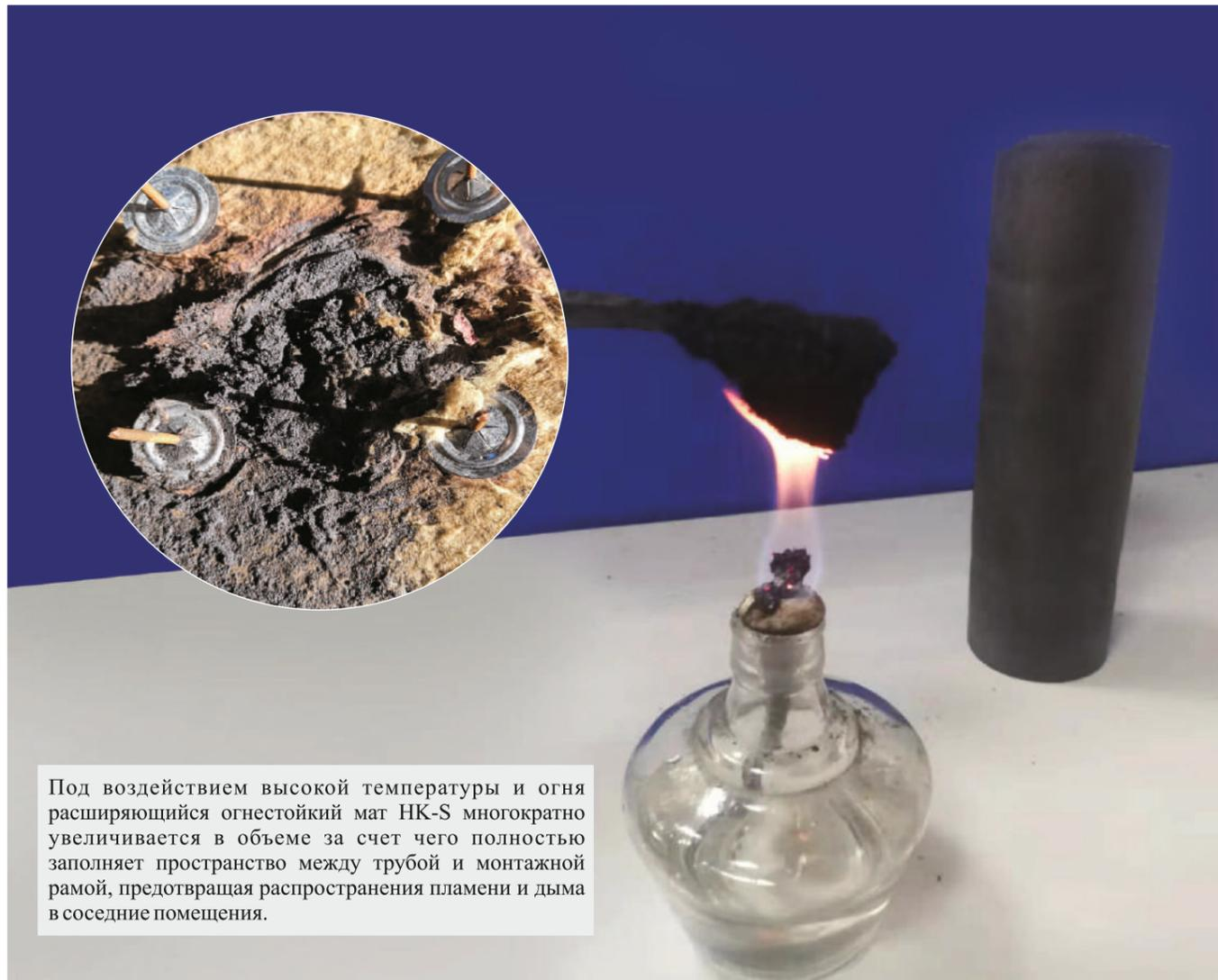
Под воздействием высокой температуры и огня расширяющийся огнестойкий мат НК-S многократно увеличивается в объеме за счет чего полностью заполняет пространство между трубой и монтажной рамой, предотвращая распространения пламени и дыма в соседние помещения.
