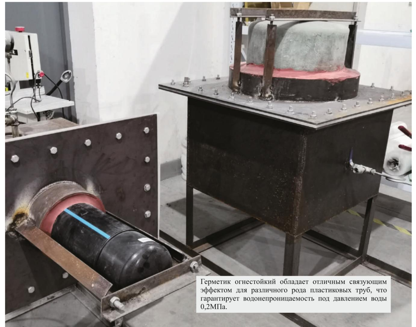
Герметик огнестойкий обладает отличным связующим эффектом для различного рода пластиковых труб, что гарантирует водонепроницаемость под давлением воды 0,2МПа.
