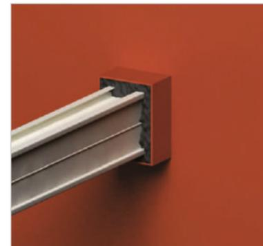
**Шаг 4:** толщина слоя герметика НК-M должна быть не менее 15 мм.
