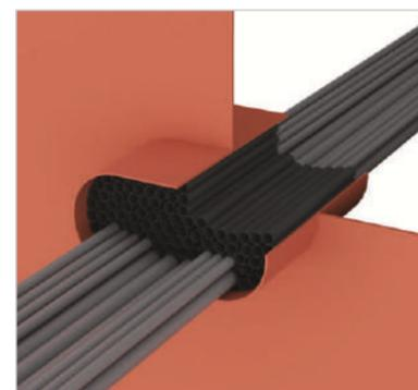
**Шаг 3:** трубки размером 27/19 и 19/12 используйте для заполнения оставшегося пространства.
