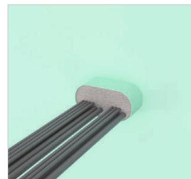
**Шаг 4:** после завершения монтажа масса НК-16 будет набирать прочность и образовывать газонепроницаемую огнестойкую оболочку. Обеспечить статичность кабелей до полного высыхания массы. Для выравнивания слоя массы и ее придавливания использовать плоский инструмент, к примеру шпатель. Для проверки на наличие/отсутствие зазоров между слоями массы используйте фонарик.
