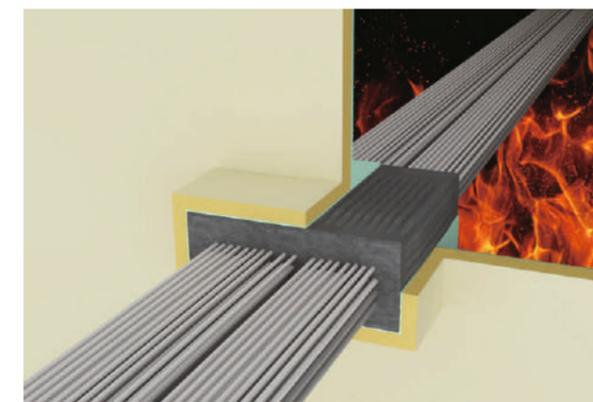
**Шаг 4:** система огнестойкая НК-MG набирает свои огнеупорные свойства класса А0-А60 до окончания полного высыхания герметика
