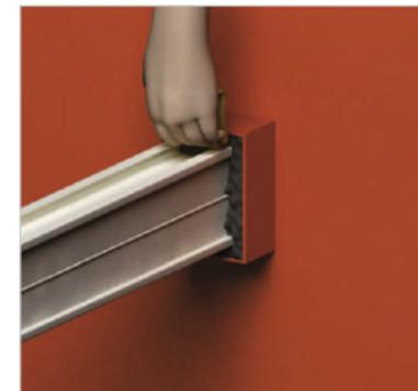
**Шаг 5:** прижмите и разгладьте влажной тканью верхний слой герметика с обоих концов проходки.
