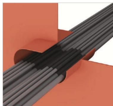
**Шаг 2:** оберните кабель трубкой НК-G соответствующего размера, расстояние между кабелями должно быть не менее 5 мм.
