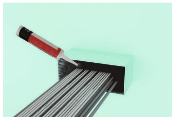
**Шаг 2:** трубки размером 27/19 и 19/12 используйте для заполнения оставшегося пространства между трубами
