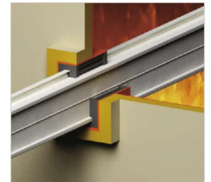
**Шаг 6:** переборка или палуба классом огнестойкости A60 должна быть заполнена изоляционным материалом в соответствии с проектом.
